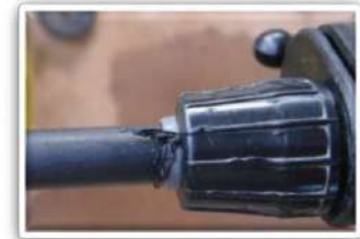
Akibat tidak mengganti pad pelincir dalam jangka masa yang lama. As a result of not replacing the lubricant pad in a long time.
