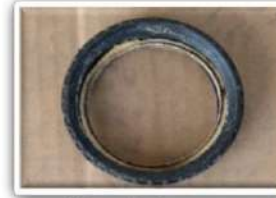
Akibat tidak mengganti pad pelincir dalam jangka masa yang lama. As a result of not replacing the lubricant pad in a long time.
